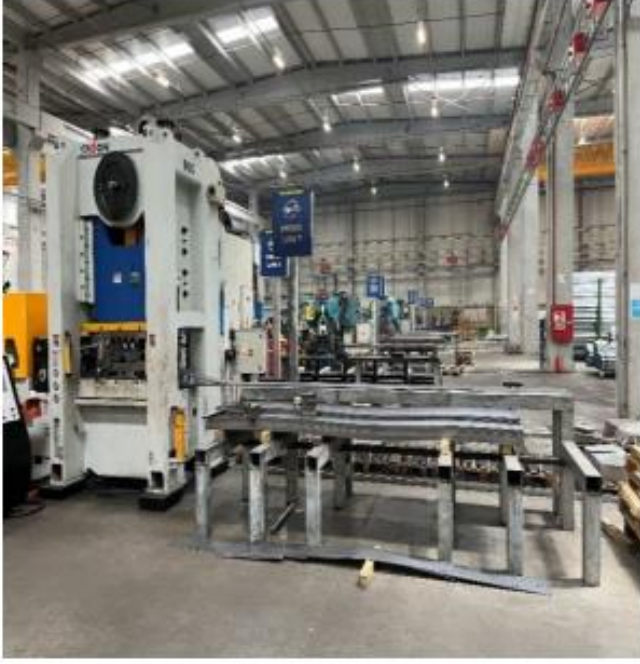
Şekil 5. Dilimlenmiş Çelik Levhaların Delinmesi İçin Pres Hattı
