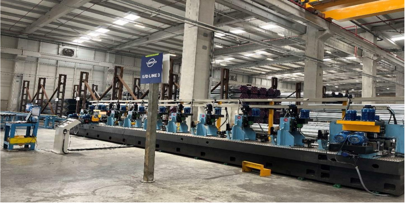
Şekil 9. Boruların Sıvanması ve Delinmesi için S&D Hattı
